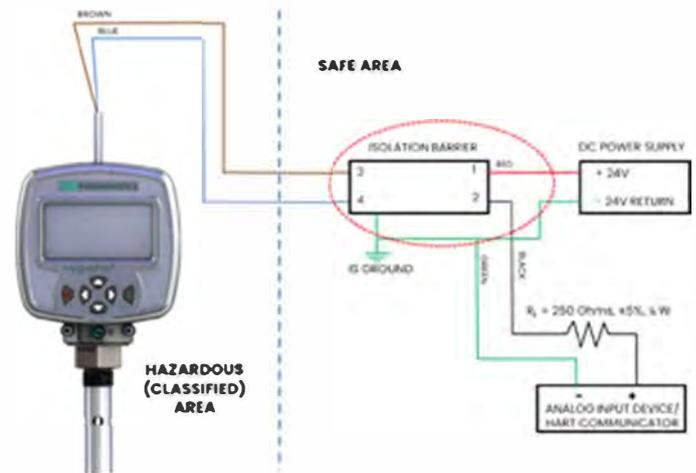
Typische Installation in explosionsgefährdeten Bereichen mit Verbindung zu einem analogen Ausgangsgerät/HART-Master mit einer optionalen widerstandsbegrenzten Isolationsbarriere
