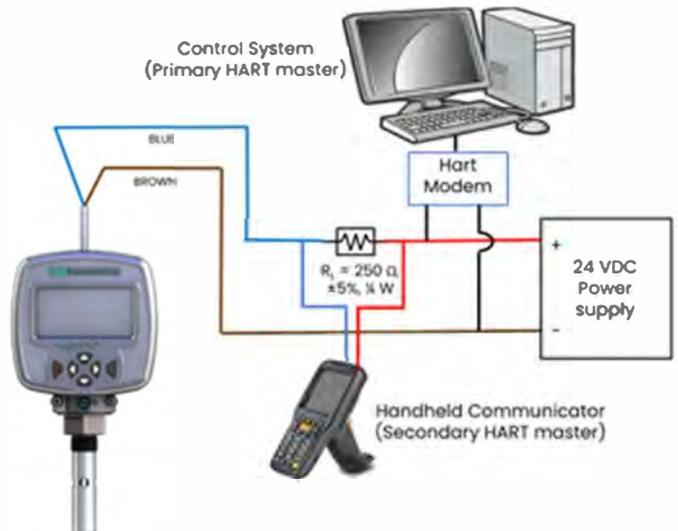
Digitale Kommunikationsverbindungen mit HART-Master-Geräten (Handheld- und Anlagensystem)
