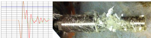
Verfälschtes Ultraschallsignal und verschmutzter Messkopf
