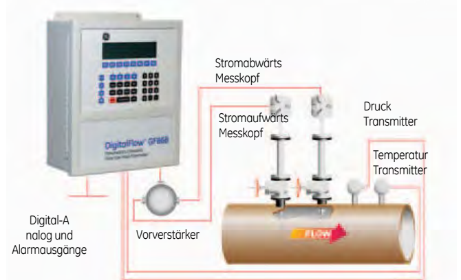
Typische Messanordnung für eine gewöhnliche Kohlenwasserstoff-Volumen- oder Massestrom
